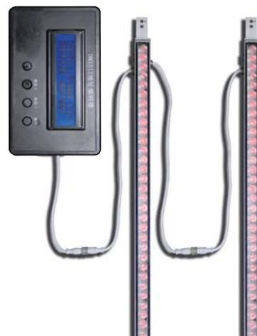
5. 再次確認已連接好DMX Linear≤21PCS,調整編碼器LCD屏幕內燈具IP地址至: “DMX512 P:001 PIX” 按“編碼”鍵確認時，燈具會閃爍10秒左右，直至靜止狀態，此狀態為編碼成功;如果有燈具不閃爍，或者一半閃爍，則燈具編碼沒有全部成功，請致電Celex LED尋求技術支援。
